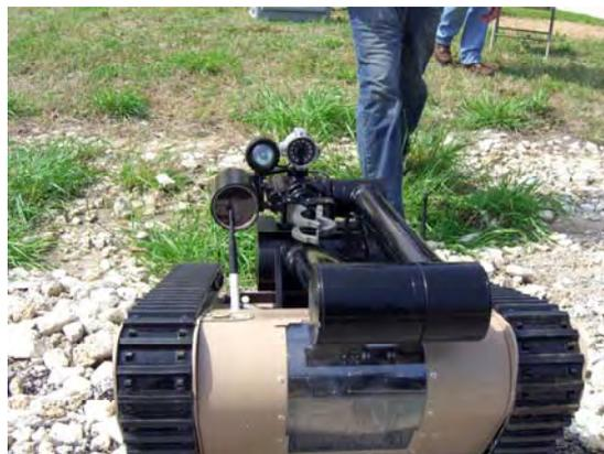
(d) 小型探査作業ロボット MATILDA
