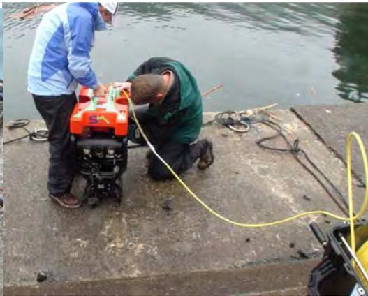
図 2-4 港湾での遺体捜索と被害調査に使用された水中ロボット（国際レスキューシステム研究機構提供）
