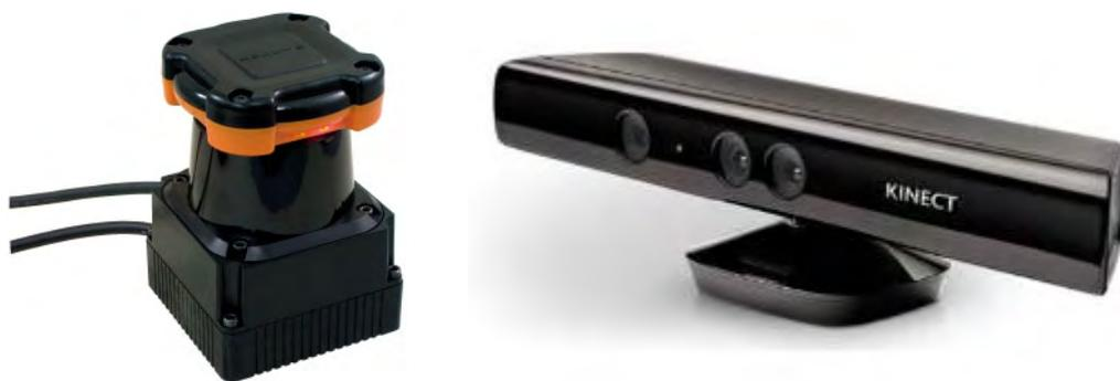
(a) 北陽電機 スキャナ式レンジセンサ UTM-30LX      (b) マイクロソフト Kinect
