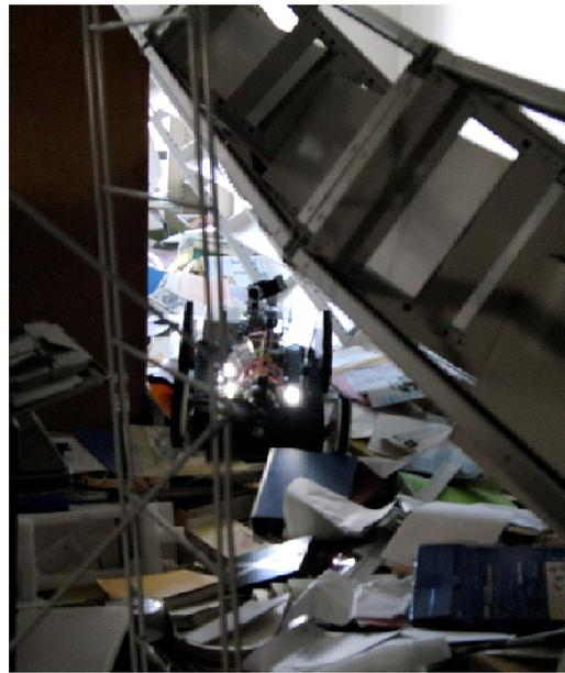
図 2-3 地震動によって被災した全壊建物内を調査する Quince（国際レスキューシステム研究機構提供）
