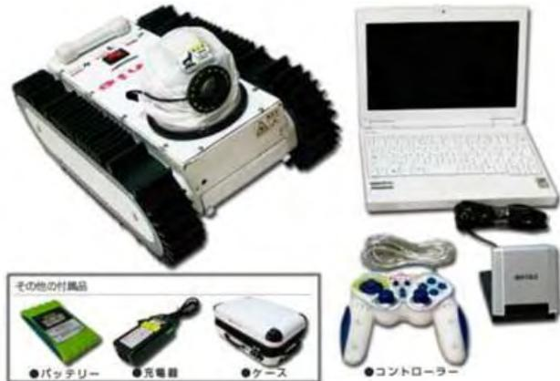
(b) 床下・設備点検走行ロボットエニーII S-90
