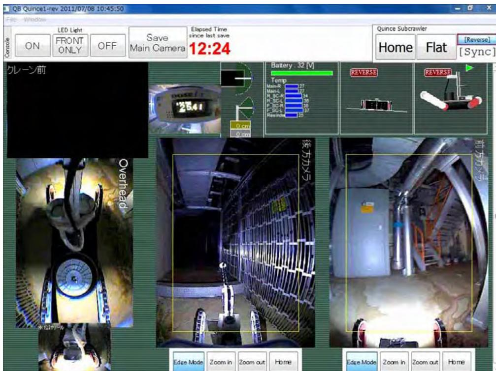
(i) 原子炉建屋の2階～5階に初めて入り、内部を調査した Quince とその操縦画面（国際レスキューシステム研究機構、東京電力提供）
