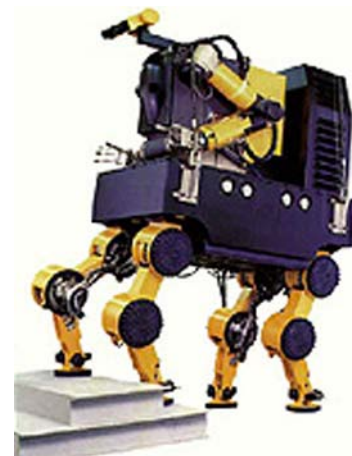
極限作業ロボット (原子力発電施設作業用) (複数社, 1983-1990)
