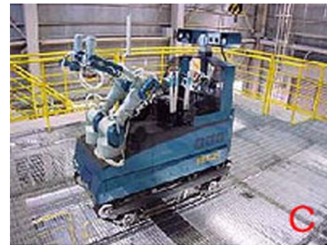
RESQ-C 試料など情報収集ロボット (日本原子力研究所)
