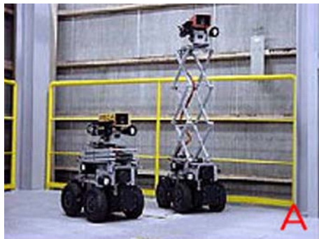
RESQ-A 初期情報収集ロボット (日本原子力研究所)
