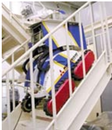
MARS-T (重量物運搬用) (三菱重工業)
