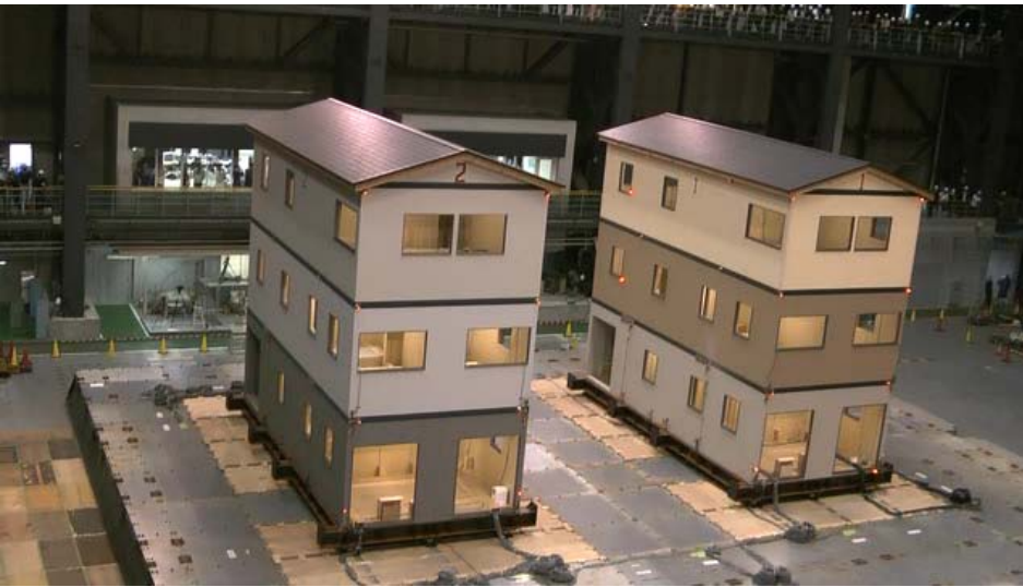
3階建て軸組構法住宅の倒壊実験
