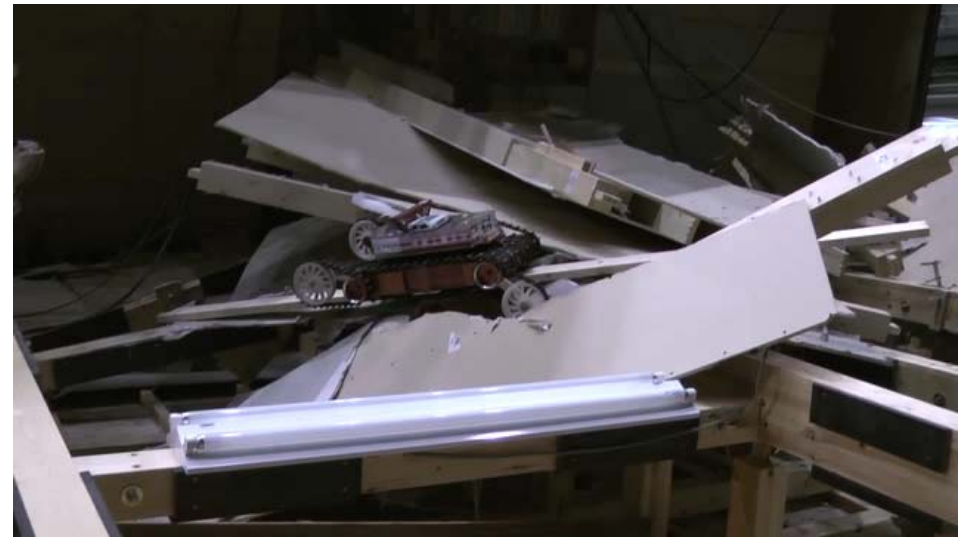
倒壊した屋根構造の走破
