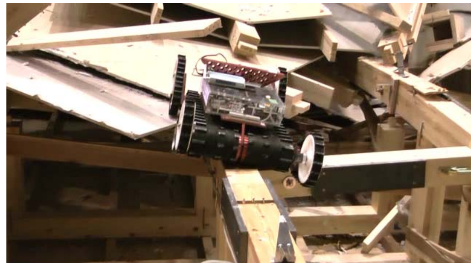
倒壊した屋根の梁の上の走破
