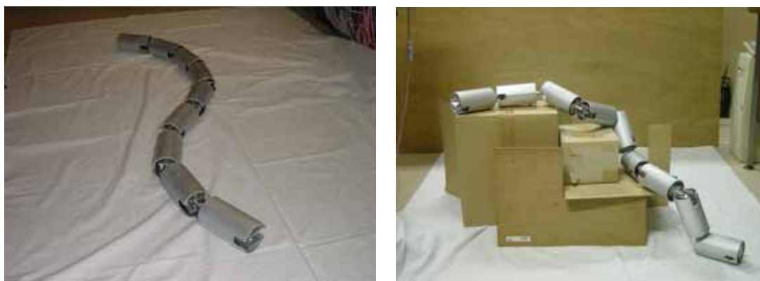
図6 ロール回転型2自由度関節による蛇型ロボットの機械モデル
