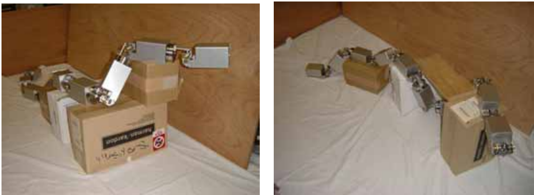
図4 改良した3自由度関節による蛇型ロボットの機械モデル
