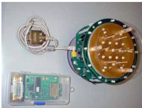
図7 位置同定基礎実験に使用したアンテナおよび発信器
