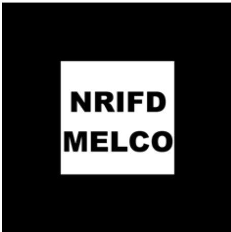
図10 地上の基準点となる2次元マーカ
